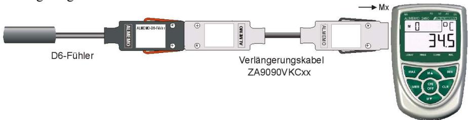
Zur Verlängerung der Fühler am Gerät dienen die universellen Verlängerungskabel ZA9090-VKCxx, bei denen die Messwerte und die Steckerprogrammierung seriell störsticher über RS485-Treiber übertragen werden. Zur Konfiguration des Sensormenüs darf die Verlängerung nicht länger als 10m sein, weil für die 2. Schnittstelle keine Treiber vorhanden sind! Der Betrieb im Sleepmodus ist bei Verwendung des Verlängerungskabels nicht möglich.
