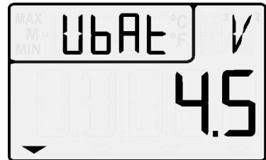
Im Anschluss sehen Sie im Hauptfeld den Messwert mit Dimension, im Funktionsfeld wird die Messstelle angezeigt. Alle möglichen besonderen Betriebszustände des Messwertes werden in 8.1 erläutert.
