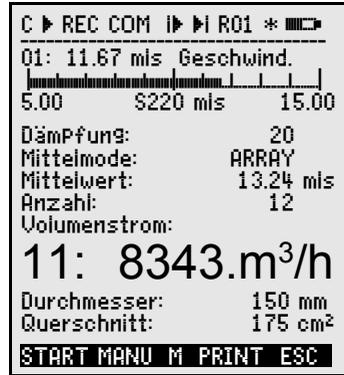
**Volumenstrom** VS = mittlere Strömungsgeschw.  $\bar{v}$  · Querschnittsfläche QF:
