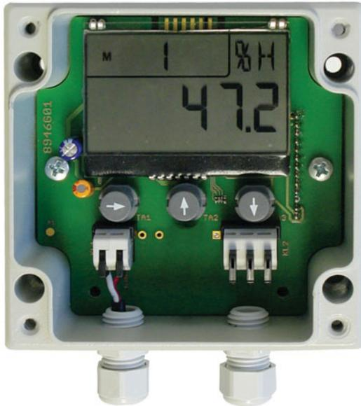
Transmitter mit geöffnetem Gehäuse
