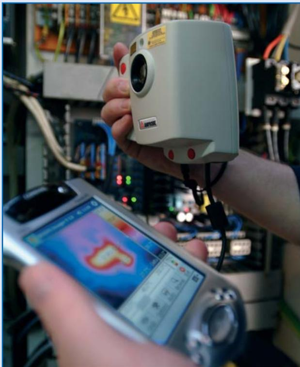
Die Kamera verfügt über eine RS-232 Schnittstelle, die Wärmebilder werden in Echtzeit direkt auf dem PDA oder Laptop angezeigt und können auf Wunsch durch einfachen Tastendruck abgespeichert und ausgewertet werden.
