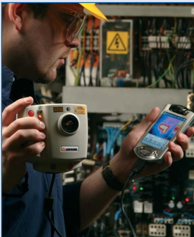
Mit der Wärmebild-Kamera lassen sich rechtzeitig Problemstellen erkennen bevor es zu Ausfällen kommt, Entscheidungen können unmittelbar vor Ort getroffen werden. Inspektionen können sicher durchgeführt werden während die Anlagen unter realer Belastung arbeiten.
