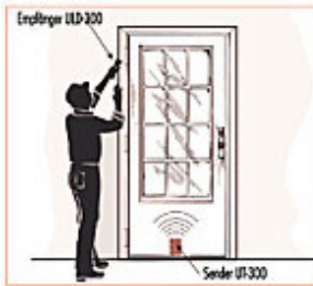
Aufspüren von Undichtigkeiten an der Tür.
