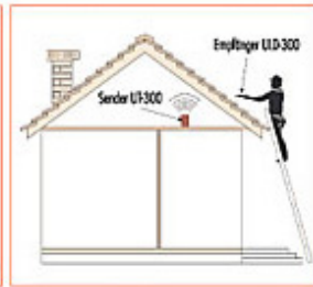
Aufspüren von Undichtigkeiten am Dach.
