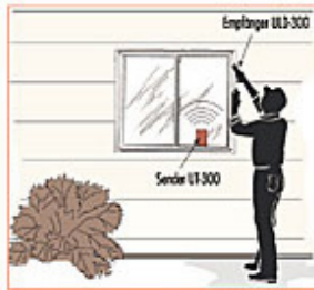
Aufspüren von Undichtigkeiten am Fensterrahmen.
