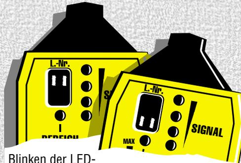
Blinken der LED-Längssegmente – Batterie leer!
