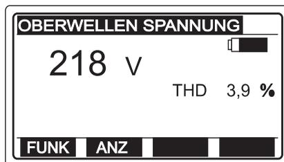
**Bild 101:** Anzeige Gesamtspannung und Klirrfaktor
