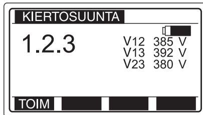
**Bild 79:** Anzeige Drehfeldmessung
