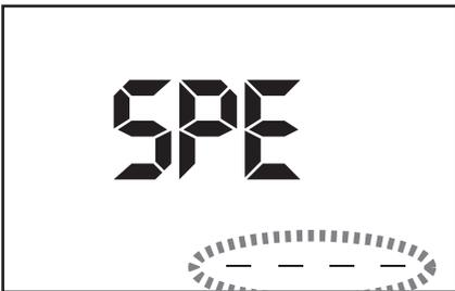
Bild 7.5: Abspeicherung von Messwerten
