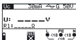
Abb. 5.14: Menü zur Berührungsspannungsmessung
