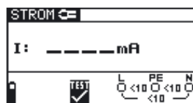
Abb. 5.47: Menü zur TRUE RMS Strommessung
