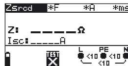
Abb. 5.31: Menü zur Messung der Schleifenimpedanz
