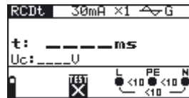
Abb. 5.17: Menü zur Auslösezeitmessung
