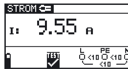
Abb. 5.49: Beispiel eines Ergebnisses der TRUE RMS Strommessung
