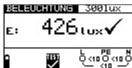
Abb. 5.52: Beispiel eines Ergebnisses der Beleuchtungsmessung
