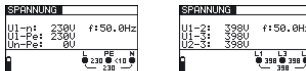
Abb. 5.41: Beispiele für Spannungs- und Frequenzmessung
