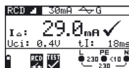
Abb. 5.20: Beispiel für ein Ergebnis der Auslösestrommessung
