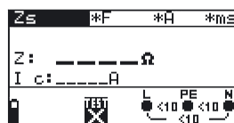
Abb. 5.28: Menü zur Messung der Schleifenimpedanz
