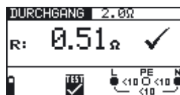
Abb. 5.12: Beispiel eines Ergebnisses der Durchgangsmessung
