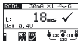
Abb. 5.18: Beispiel für ein Ergebnis der Auslösezeitmessung
