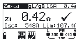
Abb. 5.32: Beispiel eines Ergebnisses der Messung der Schleifenimpedanz
