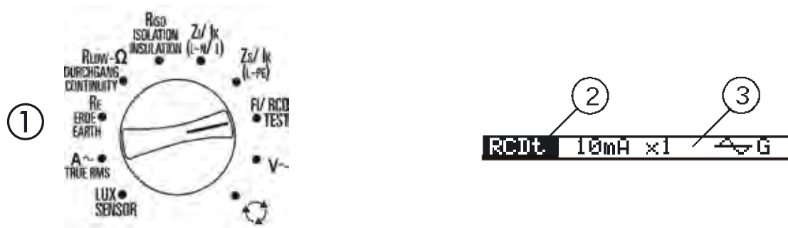
Abb. 4.2: Funktionswahl- und zugehörige Parameterzeile, Beispiel BENNING IT 120 B
