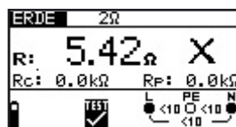
Abb. 5.46: Beispiel eines Ergebnisses der Erdungswiderstandmessung
