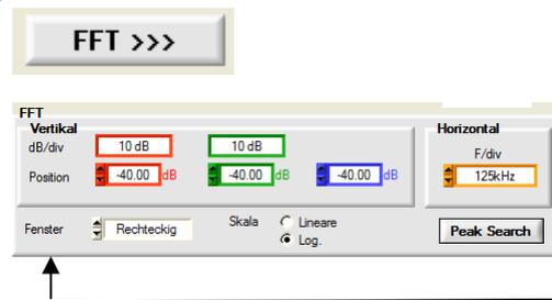
Anzeige im FFT-Modus. Ermöglicht z.B. das Auffinden des Peak Max-Wertes.
