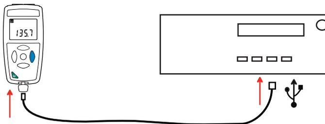
Der PC behandelt das Gerät wie einen USB-Stick und Sie können auf den Inhalt zugreifen. Allerdings wird die Data Logger Transfer-Software benötigt, um die Aufzeichnungen lesen zu können.
