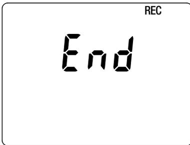
Wenn beim Starten des Geräts die Anzeige gegenüber erscheint, bedeutet das, dass ein Aufzeichnungsvorgang durch einen Ausfall der Versorgungsspannung unerwartet unterbrochen wurde.
