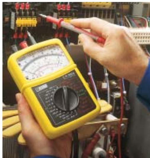
▲ Spannungsprüfung mit dem C.A. 5003. Die schwarze Prüfspitze ist in den Mehrzweck-Standbügel eingeklipst und ermöglicht so schnelle Messungen mit einer Hand.
