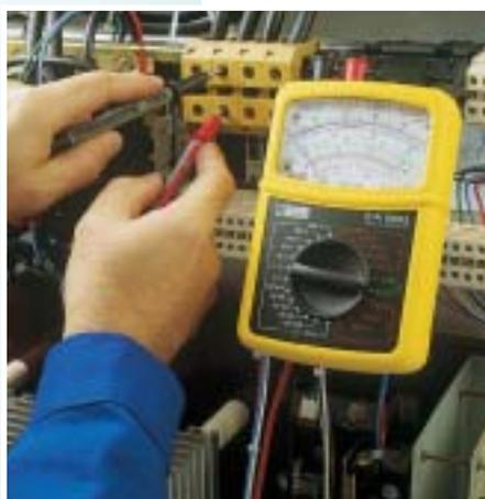
◀ Mit dem klappbaren Standbügel läßt sich das Multimeter (hier ein C.A. 5003) in der Nähe der Meßpunkte für noch bequemeres Ablesen einhängen.
