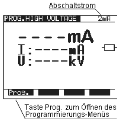
Abb. 10 - Hauptmenü der Funktion Programmierte Spannungsprüfung (PROG.HV)
