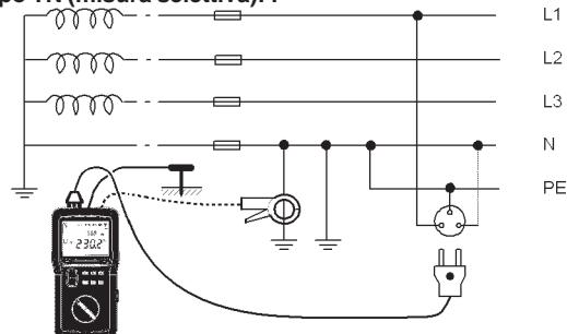
**Nota :** senza l'utilizzo della pinza, la misura effettuata fornisce il valore globale della terra di raccordo della rete, il che è poco significativo.
