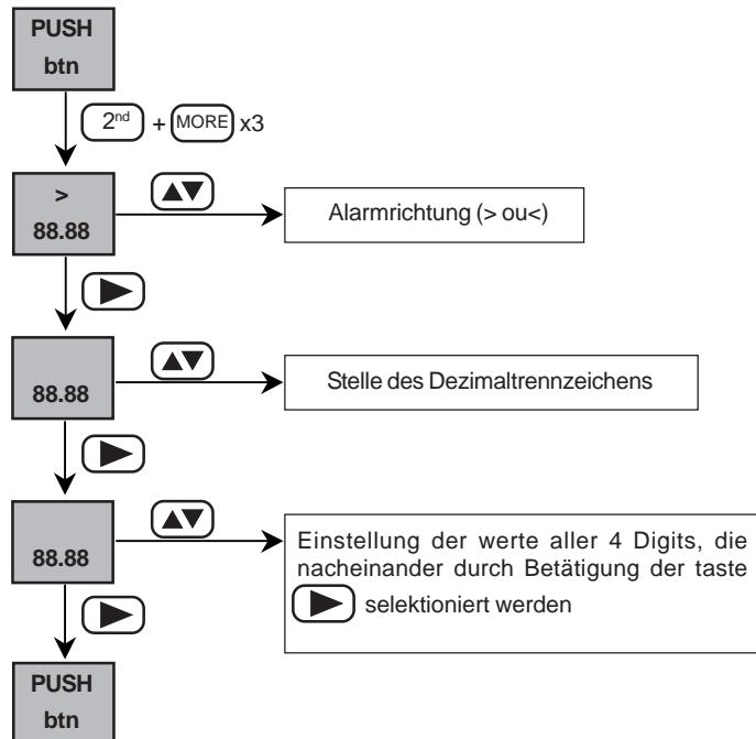
=> Falls erforderlich, kann die Alarmschwelle  $I_{ALARM}$  durch Betätigung der **ALARM** Taste aktiviert werden
