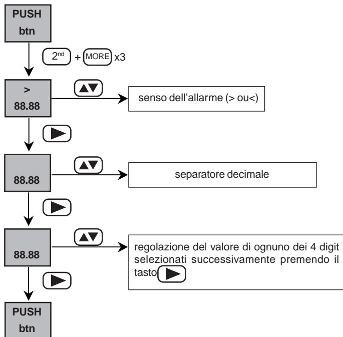
=> Se necessario, attivare la soglia d'allarme  $I_{ALARM}$  mediante pressione sul tasto **ALARM**
