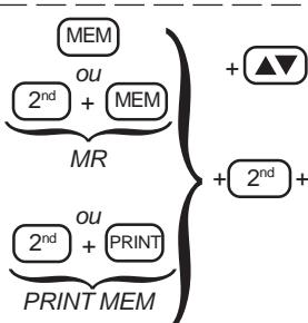
⇒ Inkrementierung des Datensatz- (OBJ) oder des Zeilenwertes (TEST)
