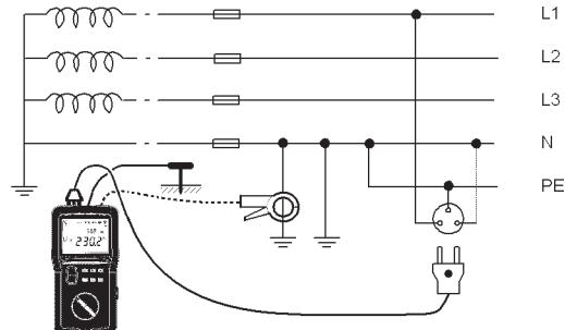
**Nota :** sin el uso de la pinza, la medida efectuada proporciona el valor de la tierra global de conexión de la red, lo que es poco significativo.
