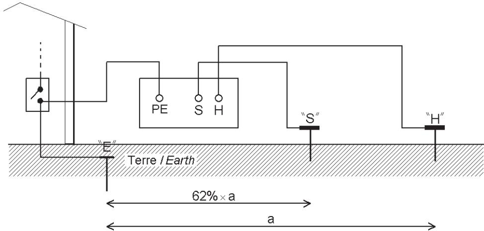
**Remarque :** pour être sûr que le piquet S est située dans une zone non influencée par d'autres prises de terre, déplacer ce piquet de ( 10% de la distance et répéter la mesure. Le résultat de mesure ne doit pas varier ou seulement de quelques % près.
