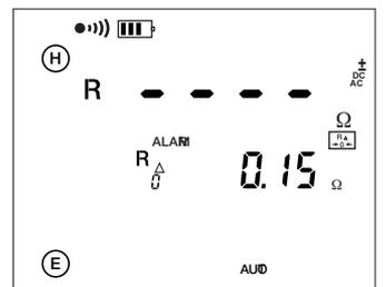
Der Kompensationswert der Messleitungen geht verloren, sobald der Drehschalter betätigt wird.
