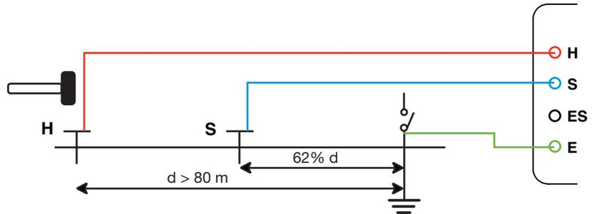
Um Beeinflussungen und induktive Effekte auszuschließen, sollten Sie die Messleitungen stets komplett von der Haspel abwickeln, und diese so weit wie möglich voneinander entfernt verlegen und ohne Schleifen auflegen. Vermeiden Sie außerdem zu große Nähe oder parallel zu metallischen Leitern (Kabeln, Schienen oder Metallzäunen). Nun schließen Sie die Leitungen an die Buchsen H und S, lösen die Potential-Ausgleichsschiene und schließen die Buchse E an den zu messenden Erder an.
