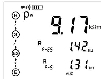
Im Erdreich liegende Metallteile (Bahngeleise, Rohrleitungen usw.) oder Wasseradern können den Widerstand in einer Richtung stark beeinflussen. Daher empfiehlt es sich, die Ausrichtung der Erdspieße nach einer ersten Messung um 90° zu drehen, um Richtungseinflüsse zu erkennen, und erneut zu messen. Außerdem empfiehlt es sich, den Abstand d mehrmals zu verändern, um sicher zu gehen, dass keine lokalen Einflüsse die Messung verfälschen.
