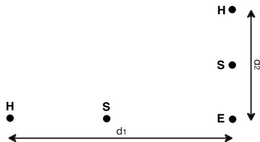
Wenn Sie dann dieselben Werte erhalten, können Sie der Messung vertrauen. Sind die Werte stark unterschiedlich, kann es sein, dass Erdströme oder eine unterirdische Wasserader Einfluss auf die Messung nehmen. Weitere Maßnahmen, um den Übergangswiderstand von Erdspeiß zu verringern, sind tieferes Einstecken und Befeuchten des Bodens.
