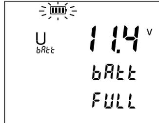
Vor der ersten Verwendung muss der Akku vollständig aufgeladen werden. Ladevorgang bei 0 bis 40°C.
