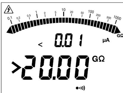
Sollte bei der Isolationsmessung ein Messwert auftreten, der den Messbereich überschreitet (dieser hängt von der Prüfspannung ab), erfolgt eine Meldung durch das Gerät.
