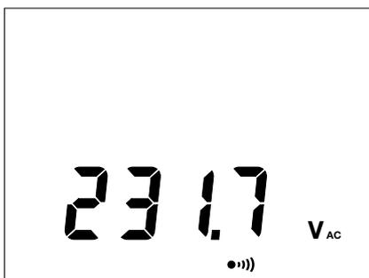
Bei der Schalterstellung **MΩ** zeigt das Symbol
