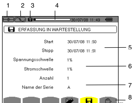
Abbildung 20: Bildschirm Programmierung einer Erfassung (in diesem Beispiel wurde die Erfassung gestartet)
