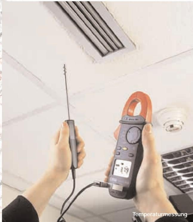
Durch Hinzufügen eines einfachen Fühlers misst die Funktion Temperatur der Zangen F03 und F07 wie hier die Umgebungstemperatur oder eine Oberflächentemperatur in °C oder in °F
