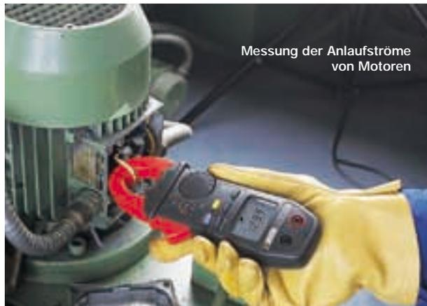
Messung der Anlaufströme von Motoren
