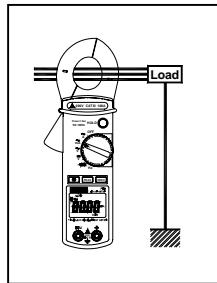
**Note :** Par mesure de sécurité, déconnecter les cordons de mesure de la pince avant d'effectuer cette opération. La mesure est optimale avec le conducteur centré au milieu des mâchoires
