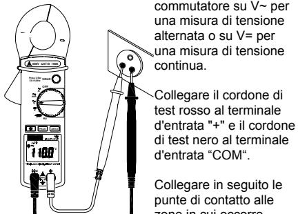
Posizionare il commutatore su V~ per una misura di tensione alternata o su V= per una misura di tensione continua.
