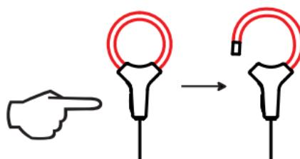
Ábralos, y luego colóquelo alrededor del conductor atravesado por la corriente a medir (un solo conductor en el sensor).
