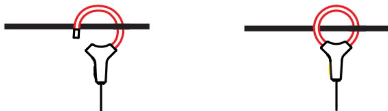
Messschleife wieder schließen. Für optimale Messergebnisse muss der Leiter mittig in der Messschleife ausgerichtet sein, die Messschleife selbst muss so kreisförmig wie möglich gelegt werden.
