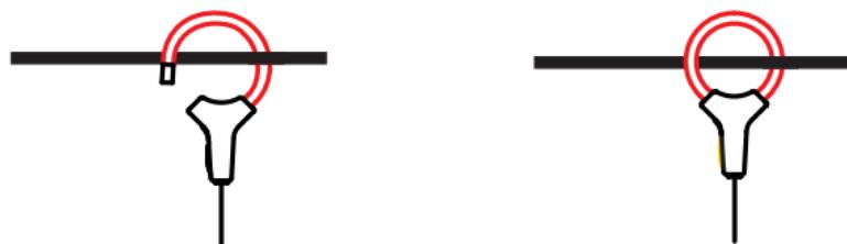
Richiudete il toro. Onde ottimizzare la qualità della misura, occorre centrare il conduttore nel captore e conferire a quest'ultimo la forma più circolare possibile.
