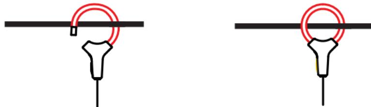
Cierre el toroidal. Para mejorar la calidad de la medida, conviene centrar el conductor en el toroidal y dar a éste una forma la más circular posible.
