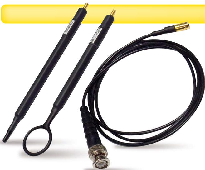
Der SONDENSATZ HX0082 enthält 2 Nahfeldsonden (30 MHz – 3 GHz) mit denen sich Magnetfelder im Funkfrequenzbereich messen lassen. Sie können in bis zu 10 cm Entfernung vom Objekt benutzt werden. Mit einer Kontaktsonde lassen sich genaue Messungen auf Masseflächen oder Leiterbahnen von gedruckten Schaltungen durchführen.
