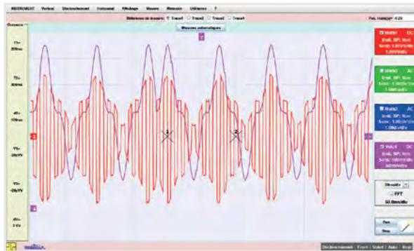
Die **vertikale Auflösung mit 10 Bits** ist viermal so hoch wie bei einem **herkömmlichen 8-Bit-A/D-Wandler** und lässt sich durch die grafische »Winzoom«-Funktion nochmals verbessern. Die automatischen Messungen oder per Cursor werden numerisch auf 4 Stellen genau angezeigt.
