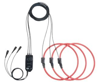
Die große Länge der Stromschleifen (bis 120 cm) erlaubt es, selbst Kabel mit großem Querschnitt oder mehrere Leiter gleichzeitig zu umschließen. Mit dem Einphasen-Modell **A 110** sind Messungen bis 30  $kA_{AC}$  möglich.
