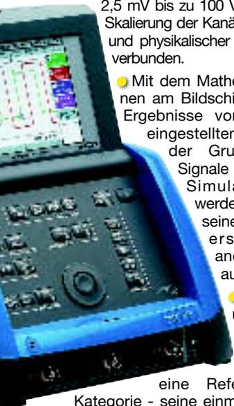
eines anderen Oszilloskops, auch eine 20-fach höhere Aufzeichnungsdauer oder eine 20-fach größere Abtastrate bedeutet, das heißt, auch eine bessere Auflösung zur besten Nutzung der Zeitbasis (1ns bis 200s / div. und bis 50 GS/s).
