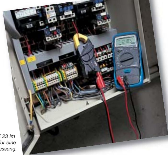
Das MX 23 im Einsatz für eine Strommessung.
