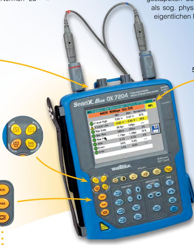
**Farb-TFT-LCD-Touchscreen** mit 5,7" LED-Hintergrundbeleuchtung, Auflösung 320 x 240 Pixel
