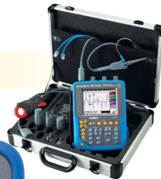
Die Betriebsarten Oszilloskop, Multimeter, Oberschwingungsanalysator und Recorder sind jeweils direkt über die Frontplatte des Instruments zugänglich.
