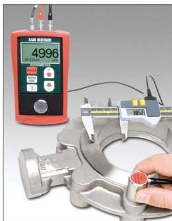
Schallgeschwindigkeitsmessung mit angeschlossenem Messschieber zur automatischen Wanddickenübernahme
