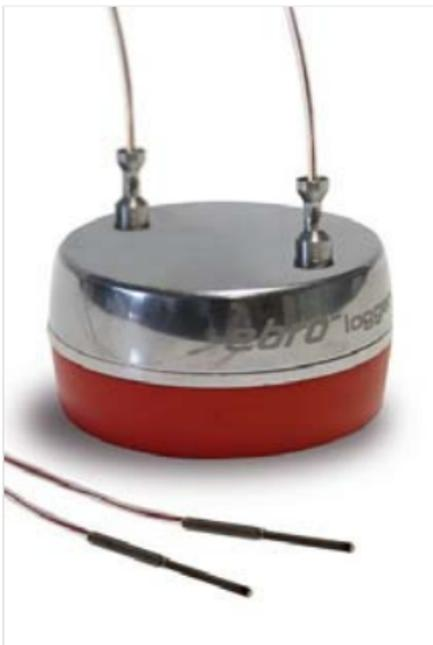
Temperaturlogger mit Funk und 2 flexiblen Drahtfühlern, Messbereich -50 °C...+150 °C, 2-Kanal, axial, Fühlerdurchmesser: 1,2 mm
