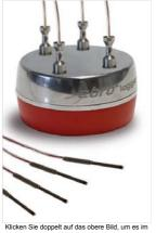
Temperaturlogger mit Funk mit 4 flexiblen Drahtfühlern, Messbereich -50 °C...+150 °C, 4-Kanal, axial, Kabellänge 600 mm, Fühlerdurchmesser: 1,2 mm
