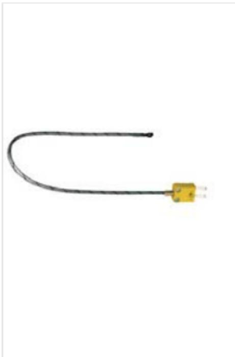
NiCr-Ni Flexibler Thermodrahtfühler 1m, bis 400°C, Außenquerschnitt 1,4 x 2,0, SMP Anschluss
