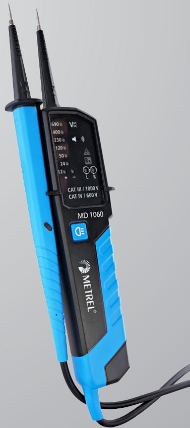
Die zweipoligen Spannungsprüfer werden gebaut und geprüft nach EN 61243-3/VDE0682. Die Spannungsanzeige erfolgt über helle LEDs, die in Bereiche von 12 - 690 V aufgeteilt sind und zusätzlich als realer Effektivwert von 0 - 690 V in der LCD-Anzeige. Beide Modelle bieten Spannungsmessung, Durchgangsprüfung, einpolige Phasenprüfung sowie eine Drehfeldprüfung.
