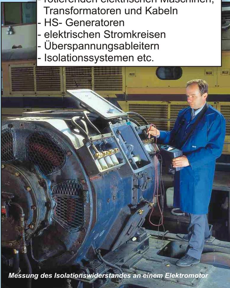
Messung des Isolationswiderstandes an einem Elektromotor
