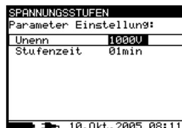
**Bild 16.** Parameter-Menu der Betriebsart Spannungsstufen Test
