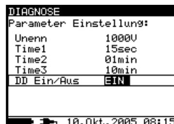
**Bild 12.** Parameter-Menü im Diagnostischen Test
