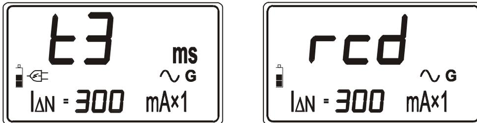
**Bild 29.** Prüfschritt 3 aktiv (Bild links) bzw. Schriftzug **r**cd, wenn der RCD ausgelöst hat (rechtes Bild) und zurückgesetzt werden muss.
