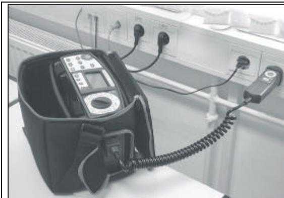
Das Prüfgerät kann aus der Tasche heraus angeschlossen werden, da seitliche Öffnungen den Anschluß der Prüfkabel ermöglichen
