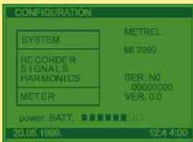
**Konfigurationsmenü** für die Einstellung der Messmethode, der Integrationszeit, des Stromskalierungsfaktors und die Signalauswahl
