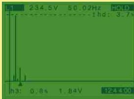
**Oberschwingungsanalyse für Spannung und Strom bis zur 63. Harmonischen**
