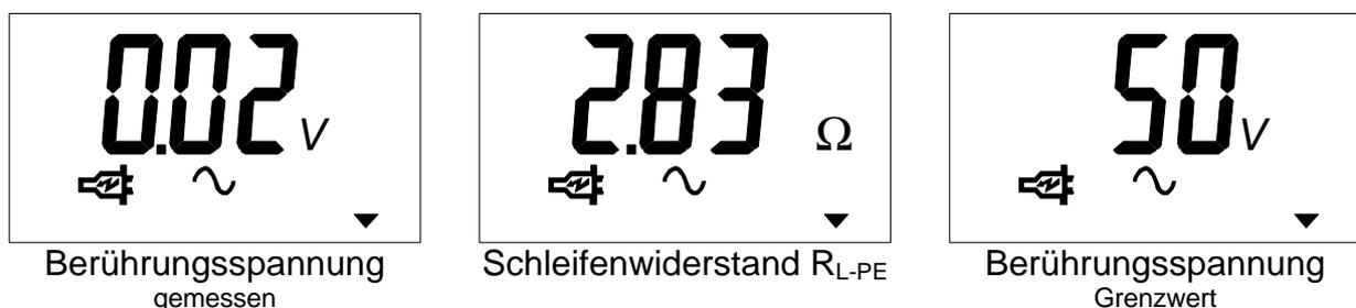
**Bild 7.** Ergebnisbeispiele (eingestellt  $I_{\Delta N} = 10mA$ ,  $U_{lim} = 50V$ ,  $0^\circ$ , AC-Typ)
