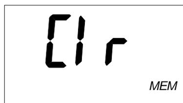
**Bild 16.** Anzeige zur Löschung des gesamten Speichers, muß mit **CLR** bestätigt werden
