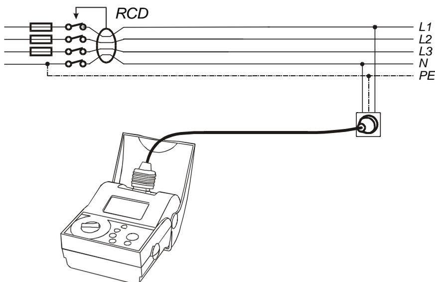
**Bild 6.** Anschluss über universelles Prüfkabel, auch für 3-Phasen-Prüfungen
