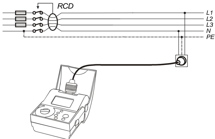
**Bild 5.** Anschluss über Prüfkabel mit Schuko-Stecker
