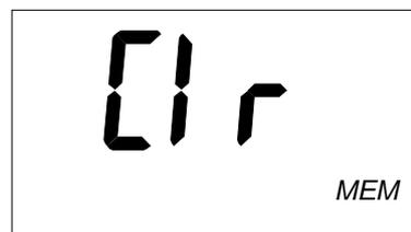
**Bild 16.** Anzeige zur Löschung des gesamten Speichers, muß mit **CLR** bestätigt werden
