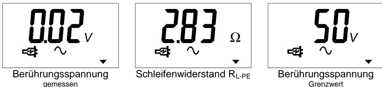
**Bild 7.** Ergebnisbeispiele (eingestellt  $I_{\Delta N} = 10\text{mA}$ ,  $U_{lim} = 50\text{V}$ ,  $0^\circ$ , AC-Typ)
