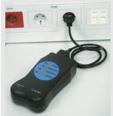
Stecker in die Dose - schon ist das Messgerät angeschlossen
