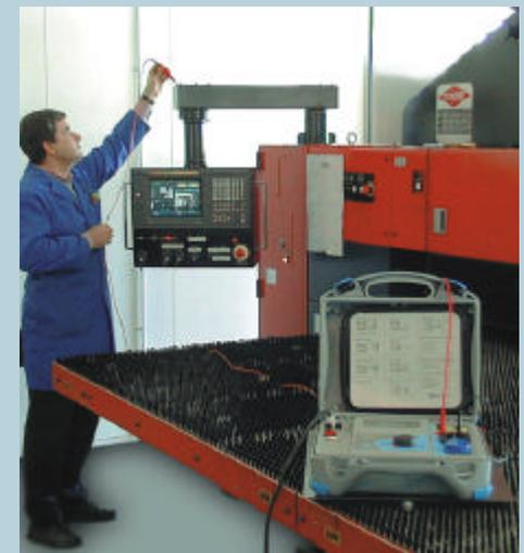
VDE 0113 Elektrische Sicherheitsabnahme einer Werkzeugmaschine
