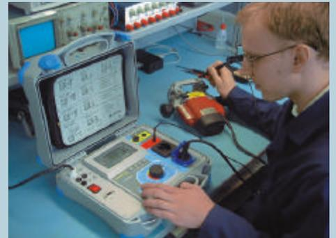
VDE 0701-Prüfung eines reparierten Gerätes
