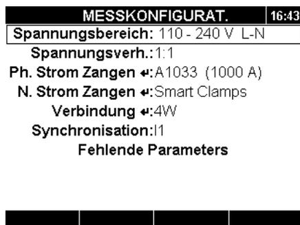
Abbildung 3.40: Der Bildschirm „MEASURING SETUP“ (Messgeräteinrichtung)
