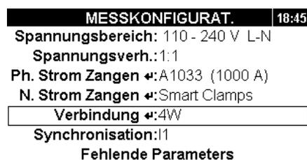
*Abbildung 4.1: Menü Messkonfiguration*
