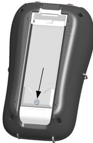
Abbildung 7.2: Schließen der Batteriefachabdeckung
