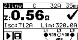
Abbildung 5.32: Beispiele für Ergebnisse der Leitungsimpedanzmessung
