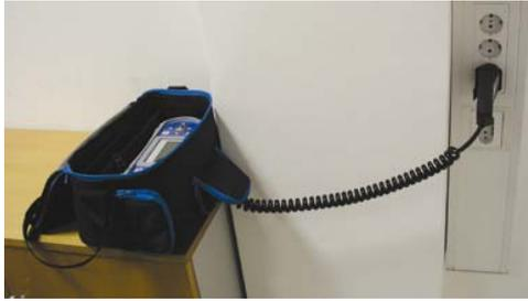
Das Messgerät kann auch in der Tragetasche liegend verwendet werden, das Prüfkabel kann über die vordere Öffnung an das Gerät angeschlossen werden.
