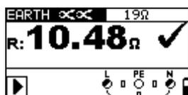
Abbildung 5.40: Beispiel für ein Ergebnis bei kontaktfreier Erdungswiderstandsmessung
