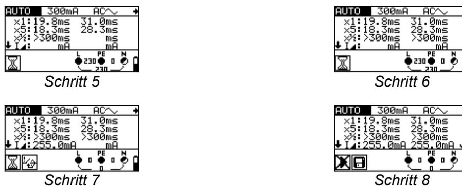
Abbildung 5.24: Individuelle Schritte bei der automatischen RCD-Prüfung
