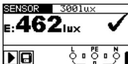
Abbildung 5.65: Beispiel eines Ergebnisses einer Beleuchtungsmessung
