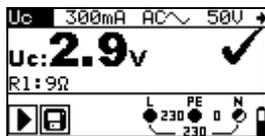
Abbildung 5.21: Beispiel von Ergebnissen der Kontaktspannungsmessung
