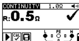
Abbildung 5.15: Beispiel für die Messung der fortlaufenden Widerstandsmessung
