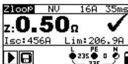
Abbildung 5.28: Beispiel eines Ergebnisses einer Schleifenimpedanzmessung
