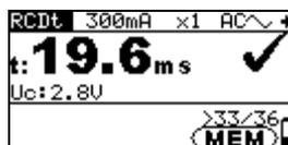
Abbildung 7.5: Beispiel eines Ergebnisses einer aufgerufenen Messung
