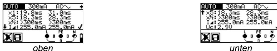
Abbildung 5.25: Zwei Teile des Ergebnisfelds bei der automatischen RCD-Prüfung
