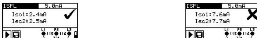
Abbildung 5.56: Beispiele für Messergebnisse der Erstfehler-Ableitstrommessungen
