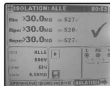
Automatische Messung des Isolationswiderstandes zwischen allen drei Leitern: L-N, L- PE und N- PE.
