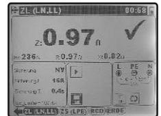
Messung der Netzzinnen-/Fehlerschleifenimpedanz zwischen L- N, L-L im Spannungsbereich von 30 V schrittweise zu 440 V. Dieser Test kann in TN, TT und IT Systemen durchgeführt werden.
