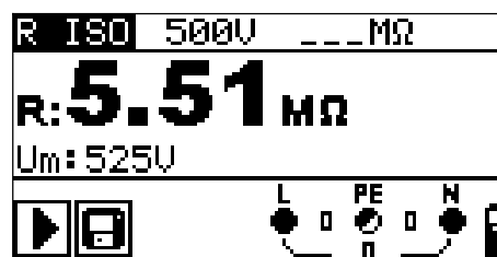
Bild 5.7: Beispiel für ein Ergebnis einer Isolationswiderstandsmessung
