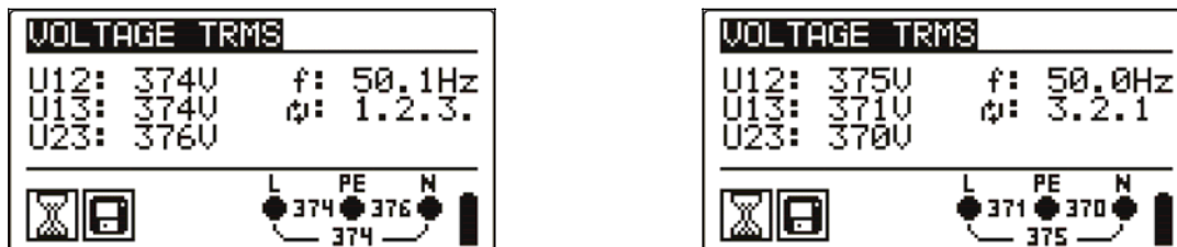
Bild 5.4: Beispiel für eine Spannungsmessung im Drehstromnetz
