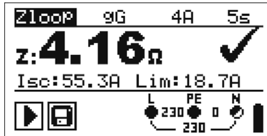
Bild 5.25: Beispiel für Messergebnisse der Schleifenimpedanz
