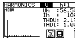
Abbildung 7.5: Beispiele für Ergebnisse der Oberschwingungsmessung
