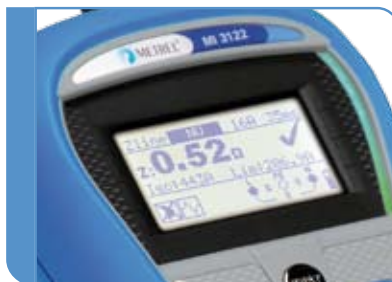
Großes LCD-Display mit integrierter Hintergrundbeleuchtung und einer GUT/SCHLECHT-Displayleuchte.
