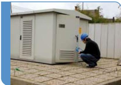
Dreileiter-Prüfmethode mit zwei externen Prüfstangen für das TT-Erdungssystem.
