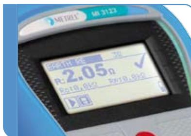
Großes LCD-Display mit Hintergrundbeleuchtung und einer GUT/SCHLECHT-Anzeigeleuchte.
