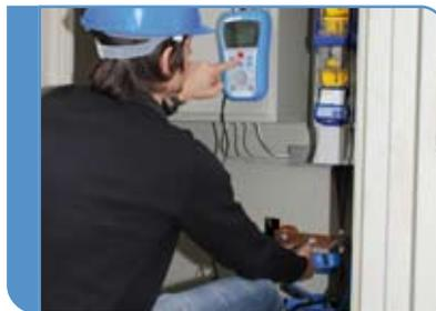
Zwei-Zangenmethode zum Prüfen des Bodenwiderstands für das TN-System.
