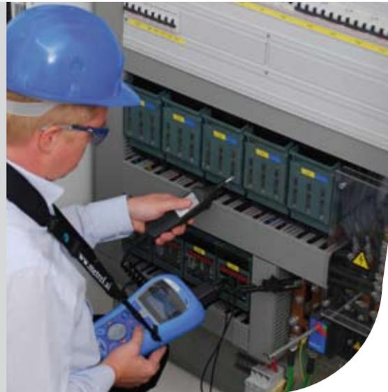
Das MI 3125B EurotestCOMBO ist ein handliches, intuitiv zu bedienendes DIN VDE 0100-600 Messgerät. Sicherungs- und RCD (FI)- Kennlinien sind bereits hinterlegt und bewerten das gemessene Ergebnis mit einer Gut/Schlecht-Aussage.
