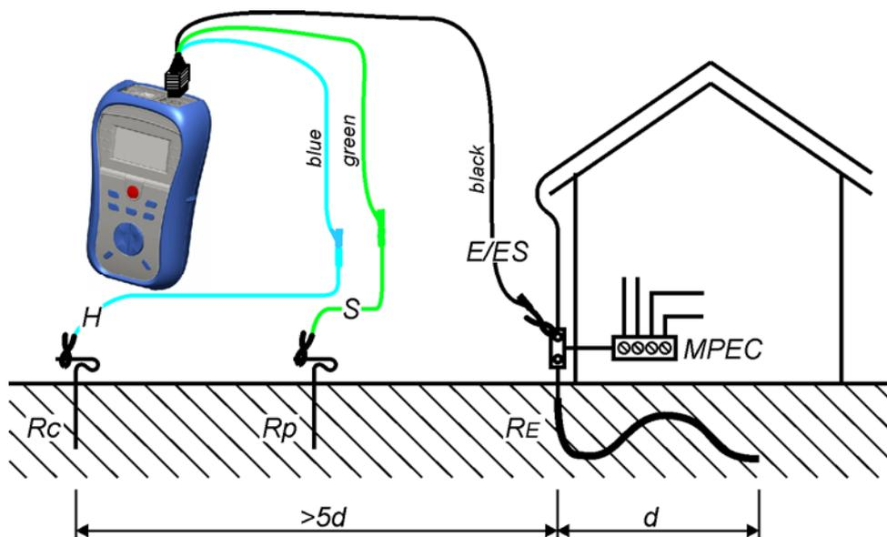
Bild 5.30: Widerstand zu Erde, Messung der Haupterdung der Anlage
