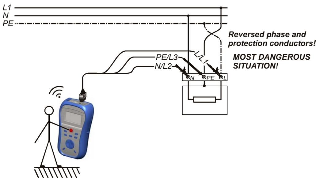
Bild 5.34: Vertauschte Leiter L und PE (Anwendung des Universalprüfkabels)
