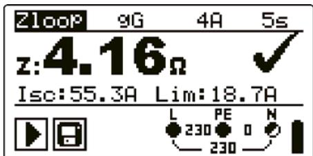
Bild 3.5: Typisches Funktionsdisplay
