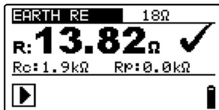
Bild 5.32: Beispiel eines Ergebnisses der Erdungswiderstandsmessung
