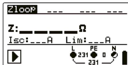
Bild 5.23: Fehlerschleifenimpedanz
