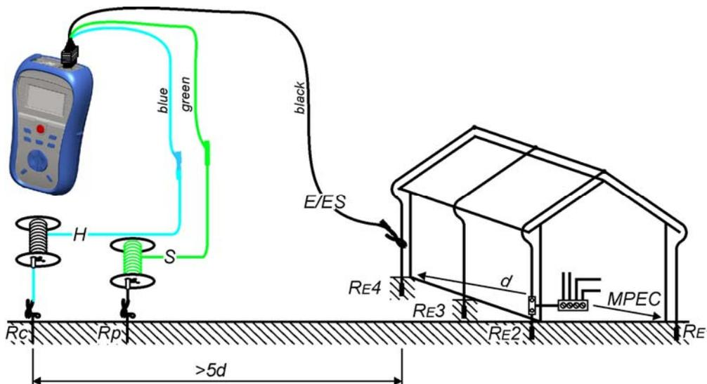
Bild 5.31: Widerstand zu Erde, Messung einer Blitzschutzanlage
