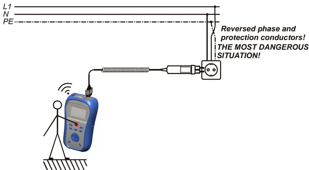
Bild 5.33: Vertauschte Leiter L und PE (Anwendung des Plug Commanders [Netzsteckeradapter])
