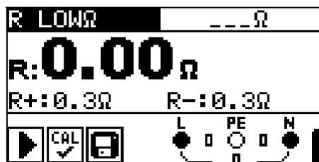
Bild 5.10: Beispiel für ein R LOW $\Omega$ -Ergebnis
