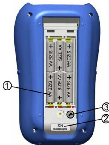
Bild 3.4: Batteriefach
